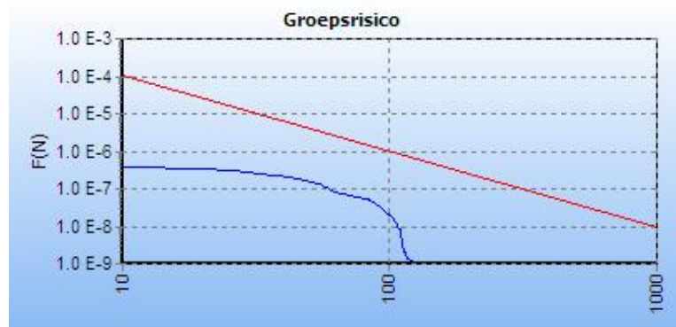
Figuur 5.4 FN curve voor A-620-KR-61tm64 van N.V. Nederlandse Gasunie voor de kilometer tussen stationing 410.00 en stationing 1410.00
