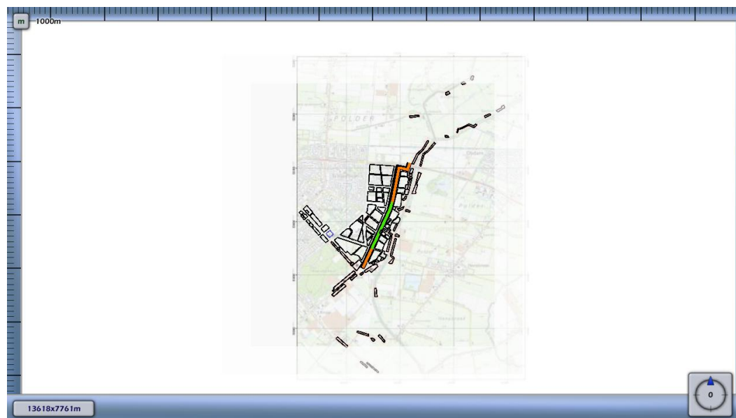
Figuur 4.8 Kilometer leiding behorende bij de maximale overschrijding van de FN-curve voor A-620-KR-61tm64 van N.V. Nederlandse Gasunie
