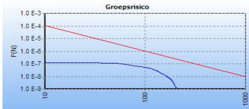
Figuur 5.1 FN curve voor A-550-KR-35tm38 van N.V. Nederlandse Gasunie voor de kilometer tussen stationing 1050.00 en stationing 2050.00
