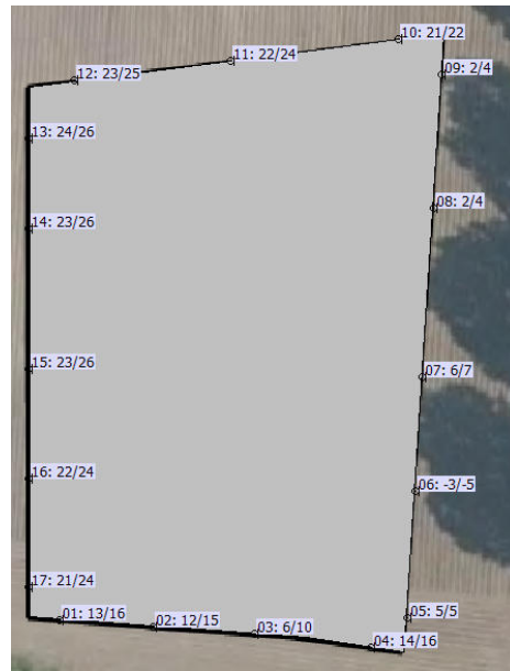
Figuur 1.8 Geluidbelasting vanwege de 30 km/uur wegen in dB L den , nieuwe situatie.
