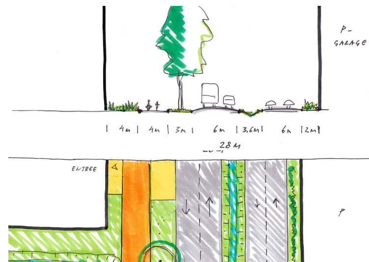
Principeprofiel C-C Ontsluitingsas
