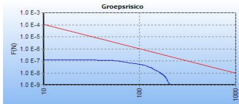
Figuur 5.1 FN curve voor A-550-KR-35tm38 van N.V. Nederlandse Gasunie voor de kilometer tussen stationing 1050.00 en stationing 2050.00
